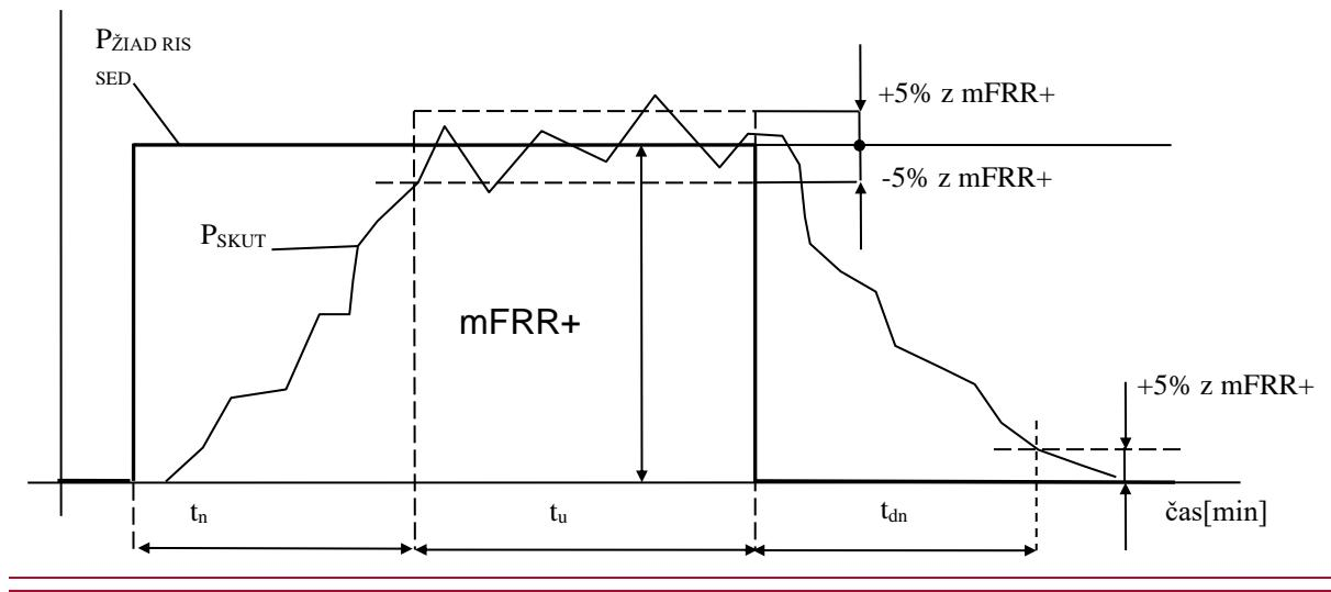
Obr. B2.16 Požadovaný priebeh výkonu pri certifikácii po aktivácii mFRR+.
