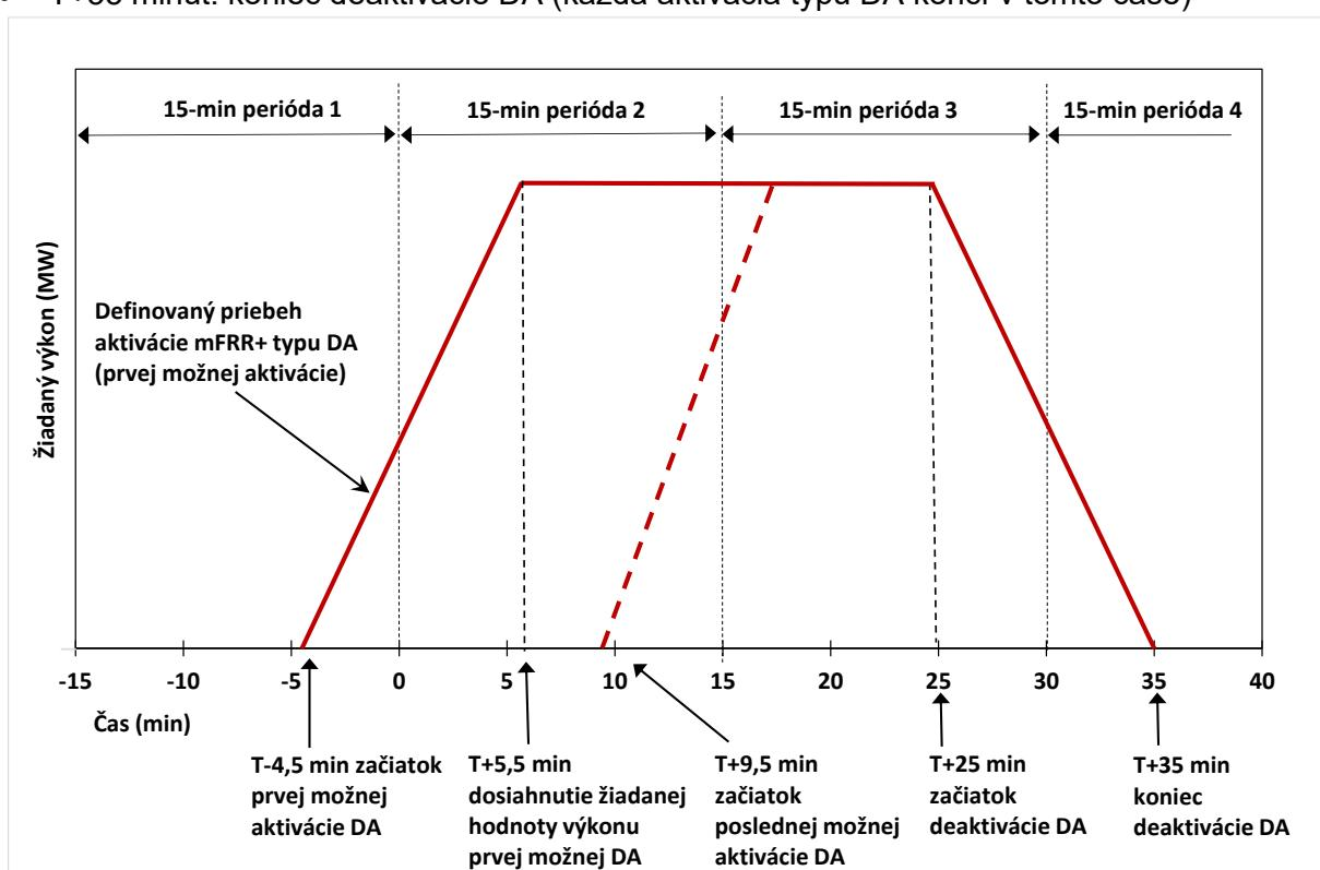
Obr. 4.3.2. b) B4.2 Definovaný priebeh aktivácie typu DA
