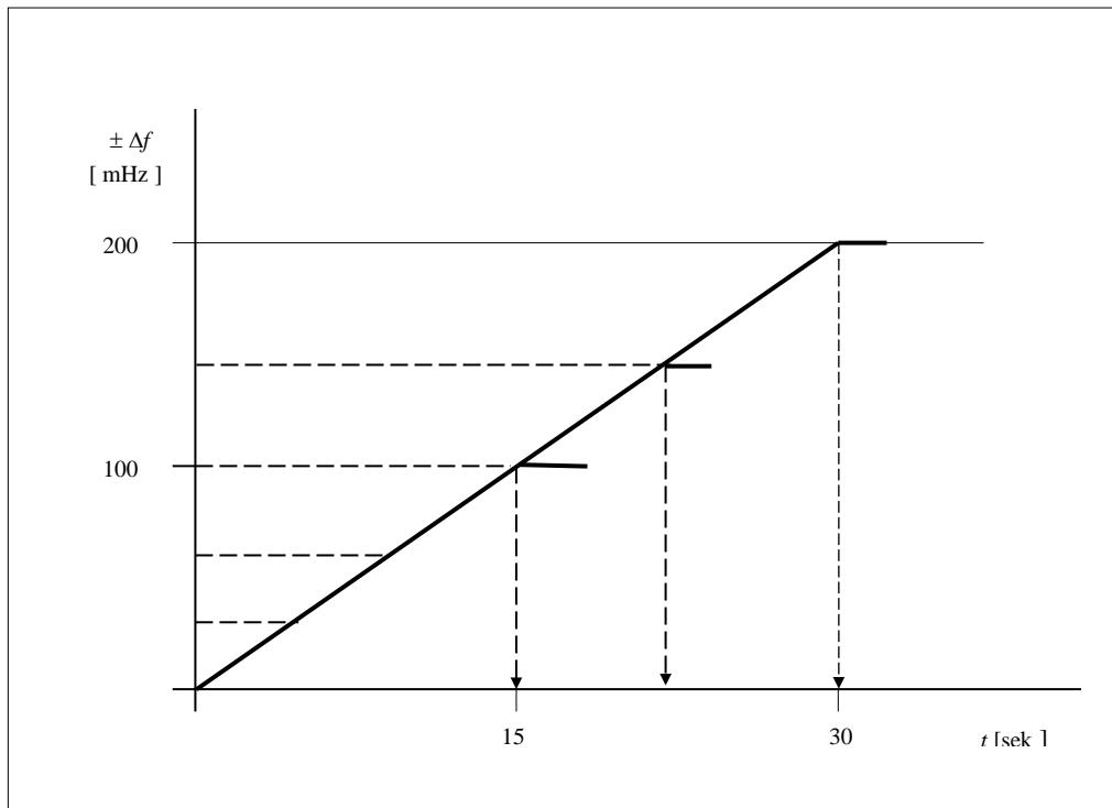
Obr. B2.1 Priamka limitnej hodnoty rýchlosť aktivácie primárnej regulačnej rezervy
