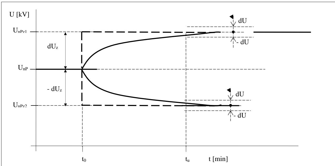
Obr. B2.1424 Požadovaný priebeh napäťia v pilotnom uzle po skokovej zmene žiadaneho napäťia
