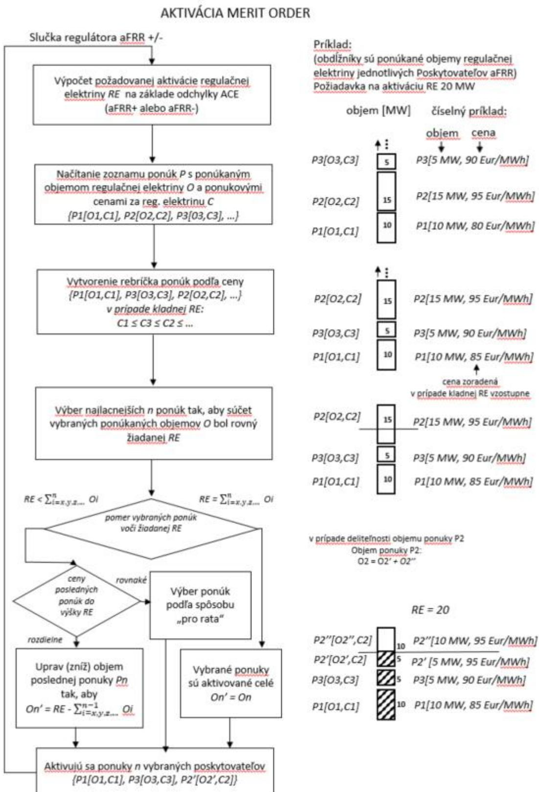
Obr. B2.5 Proces prerozdelenia žiadaneho výkonu v aFRR+/aFRR- (Merit order)
