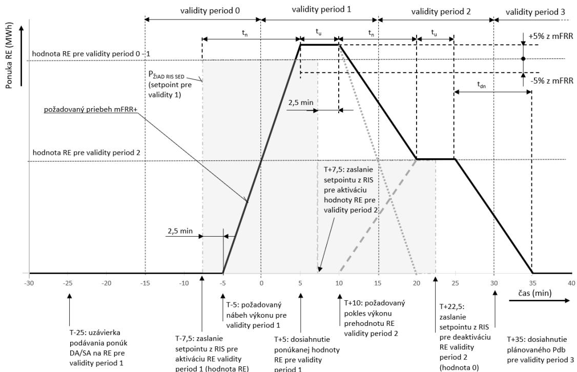
Obr.B2.130 Požadovaný priebeh výkonu pri certifikácii mFRR+ po aktivácii typu SA – zmena aktivovanej hodnoty RE platnej pre validity period 1 na hodnotu RE platnú pre validity period 2
