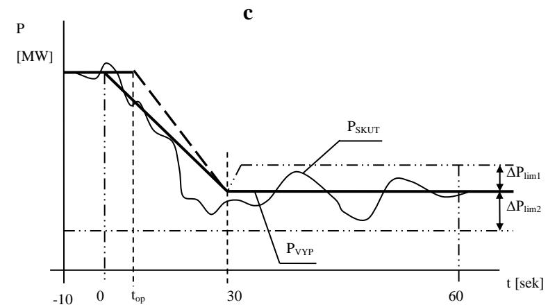
Obr. B2.3 Požadovaný priebeh výkonu pri certifikácii po aktivácii FCR
