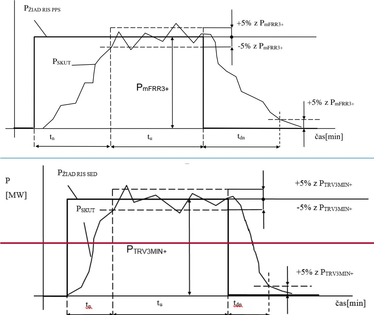
Obr.B2.940 Požadovaný priebeh výkonu pri certifikácii po aktivácii  $mFRR3+$  ( $TRV3MIN+$ ) ( $mFRR3-$ )
