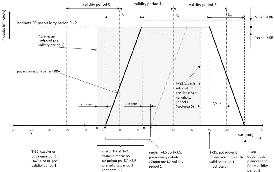
Obr.B2.129 Požadovaný priebeh výkonu pri certifikácii mFRR+ po aktivácii typu DA
