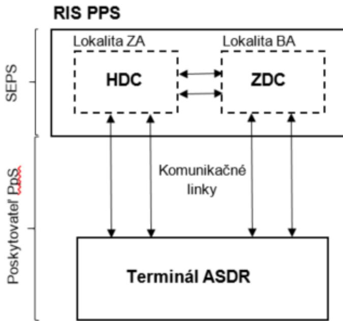
Obr. B1.1 Bloková schéma prepojenia terminálu ASDR a RIS PPS pre poskytovaní PpS
