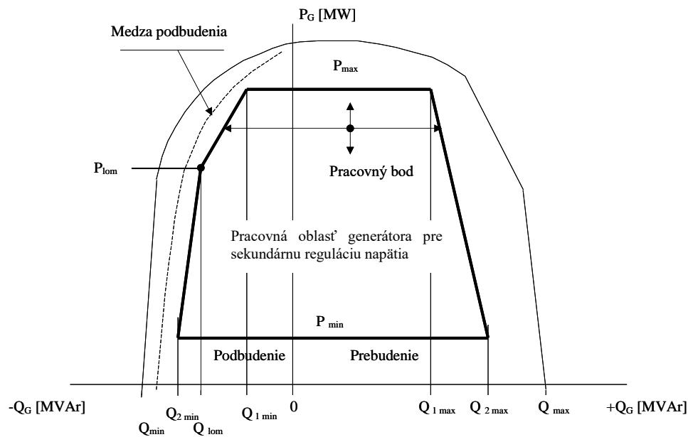
Obr. B2.1522 Obecný P-Q diagram generátora
