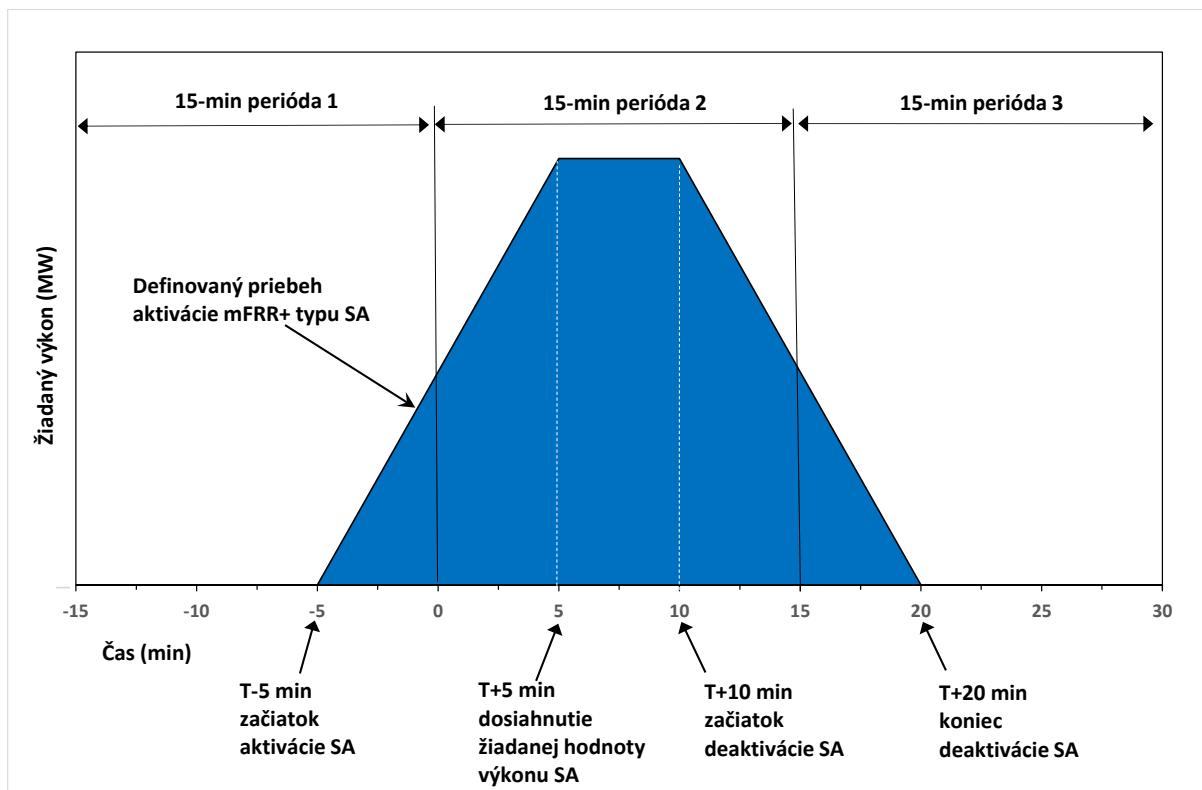
Obr. 4.3.2. a) B4.1 Definovaný priebeh aktivácie typu SA
