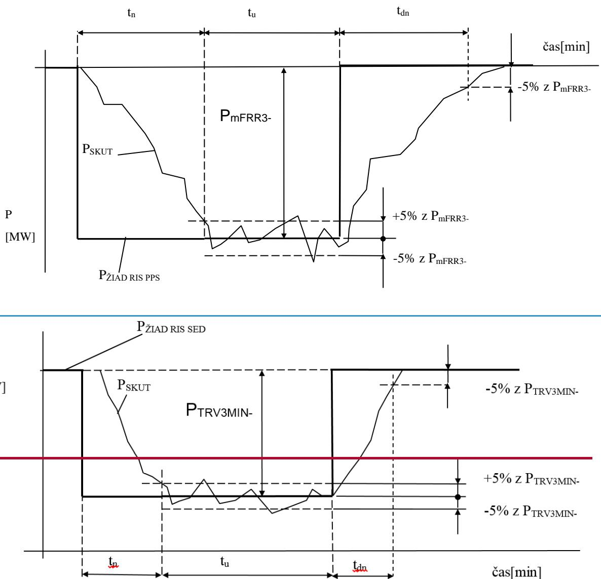
Obr.B2.104 Požadované priebehy výkonu pri certifikácii po aktivácii mFRR3-(TRV3MIN-)(mFRR3-)
