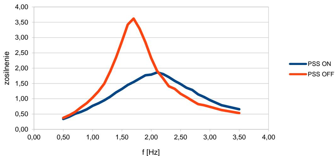
Obr. B5F4.5 Príklad amplitúdovej frekvenčnej charakteristiky činného výkonu SG
