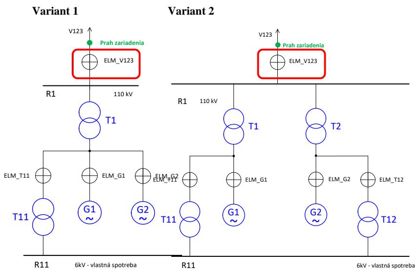
Obr. B1.7 Meranie Jednotky z dvoch fyzických blokov - spoločné
