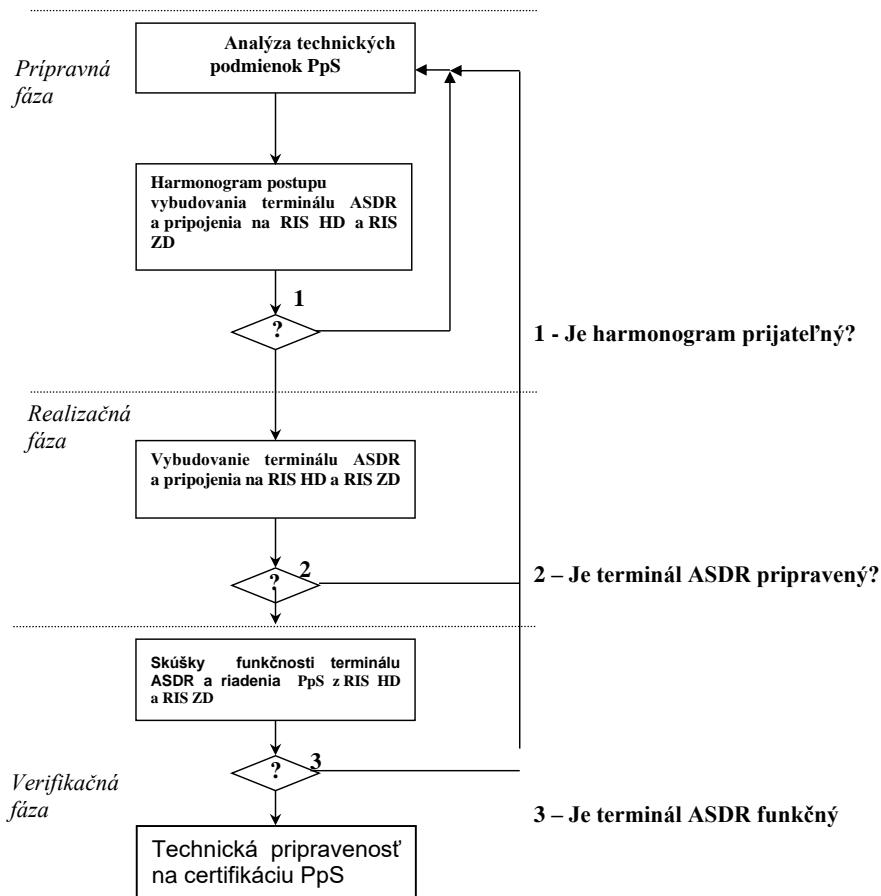
Obr. B6.F1.6 Metodika technickej realizácie pripojenia zariadenia k poskytovaniu PpS
