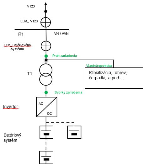
Obr. B1.11 Prah a svorky batériového systému.
