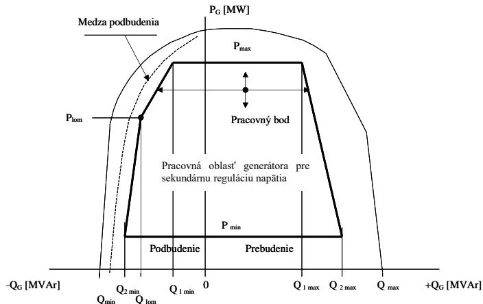
Obr. B2.1522 Obecný P-Q diagram generátora
