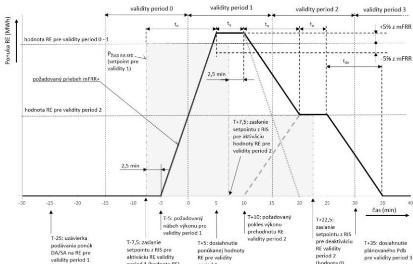
Obr.B2.1320 Požadovaný priebeh výkonu pri certifikácii mFRR+ po aktivácii typu SA – zmena aktívovanej hodnoty RE platnej pre validity period 1 na hodnotu RE platnú pre validity period 2
