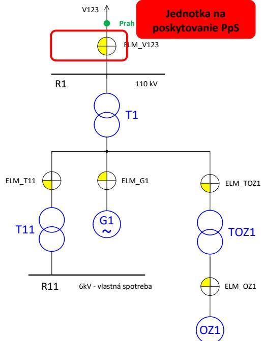
Obr. B1.12 Prah Jednotky na poskytovanie PpS (fiktívneho bloku) zloženej z odberného a výrobného zariadenia
