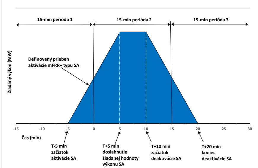
Obr. 4.3.2.-e) B4.1 Definovaný priebeh aktivácie typu SA
