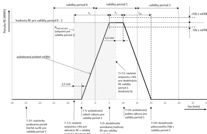
Obr. B2.118 Požadovaný priebeh výkonu pri certifikácii mFRR+ po aktivácii typu SA
