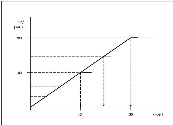
Obr. B2.1 Priamka limitnej hodnoty rýchlosťi aktivácie primárnej regulačnej rezervy
