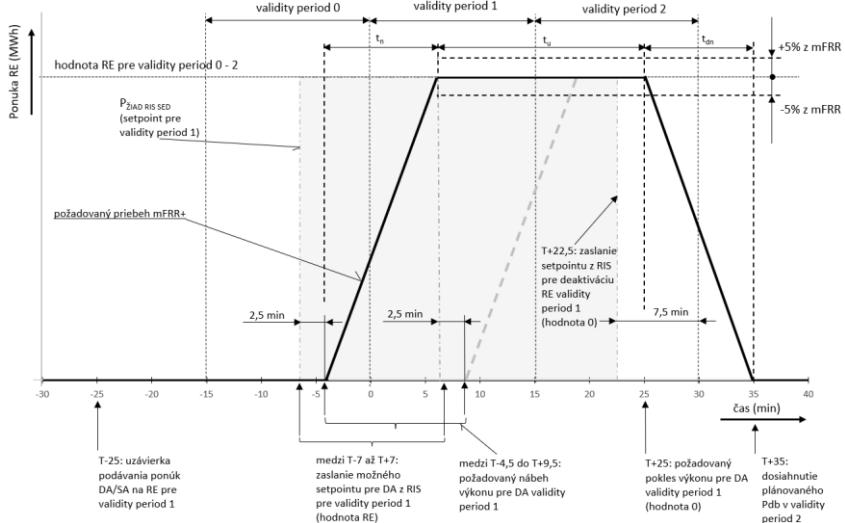
Obr.B2.129 Požadovaný priebeh výkonu pri certifikácii mFRR+ po aktivácii typu DA
