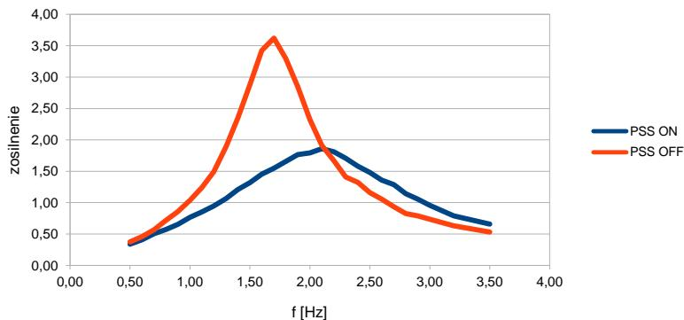
Obr. B5E4.5 Príklad amplitúdovej frekvenčnej charakteristiky činného výkonu SG
