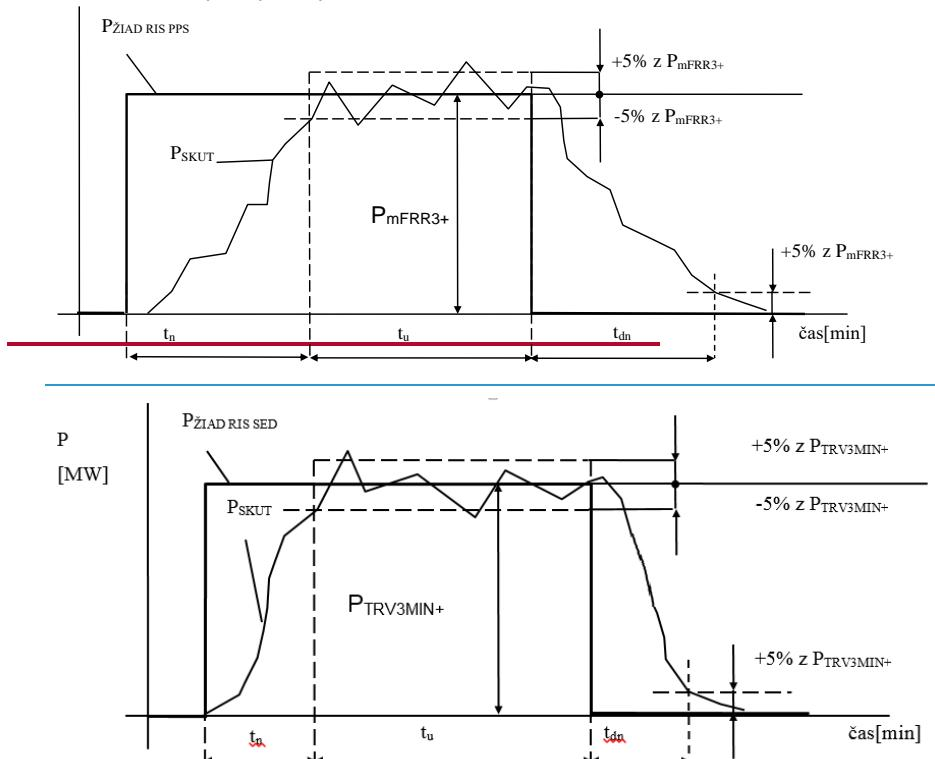
Obr.B2.940 Požadovaný priebeh výkonu pri certifikácii po aktivácii  $mFRR3+$  ( $TRV3MIN+$ ) ( $mFRR3-$ )
